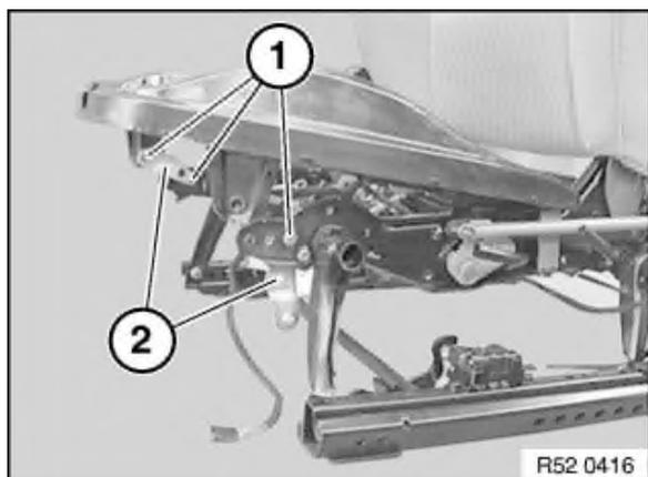
Вывернуть винт (1) и снять пластины (2) крепления.
