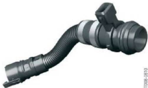
138 - Подогрев системы вентиляции картера двигателя
