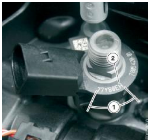
101 - Коррекция количества топлива, впрыскиваемого пьезофорсунками
