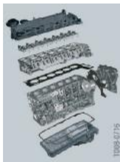
Механические узлы и детали двигателя в основном делятся на три группы: картер двигателя, кривошипно-шатунный механизм и привод клапанов. Эти три группы находятся в тесной взаимосвязи и должны быть взаимно согласованы.
