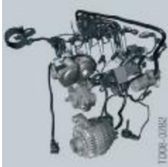
Цифровая электронная система управления дизельным двигателем объединяет задачи управления двигателем. Так, цифровая электронная система управления дизельным двигателем отвечает за анализ сигналов датчиков, установленных на двигателе или в автомобиле, а также активизацию имеющихся на двигателе исполнительных органов.
