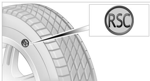
Шины Runflat можно узнать по круглой значке с надписью RSC на боковине. Колесо Runflat состоит из самонесущей шины и специального диска. Усиленные боковины позволяют, хотя и с ограничениями, продолжить движение даже на спущенной шине.
