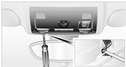
3. Снимите клавишную панель.
