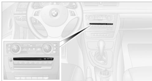
При оснащении двумя устройствами чтения дисков: верхнее устройство предусмотрено для компакт-дисков в формате „аудио“ (аудио-CD).
