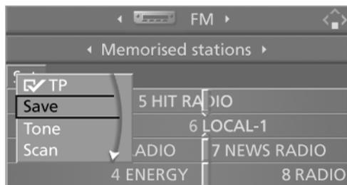
5. Поворотом контроллера выберите канал памяти. Номер канала появляется рядом с названием или частотой радиостанции.
