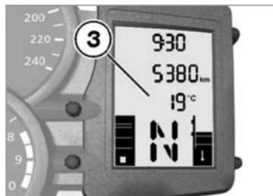
Индикация температуры воздуха **3** возможна только при работающем двигателе, в противном случае отображается символ «---».
