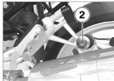
**⚠** При слишком маленьком расстоянии между задним колесом и глушителем, колесо может перегреться. Расстояние между задним колесом и глушителем должно составлять минимум 15 мм. ◀
