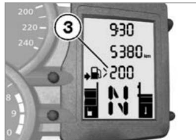
Описание, касающееся запаса хода после начала расходования резервного остатка топлива (➡ 44), относится также и к индикации запаса хода. Информация о запасе хода **3** может быть вызвана также и до того, как начнется использование резервного остатка топлива. Для расчета запаса хода используются специальные значения среднего расхода топлива, которые не всегда совпадают с выводимыми на индикацию значениями.
