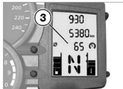
При расчете средней скорости **3** за основу берется время, прошедшее с момента последнего сброса показаний. Перемены в движении, когда двигатель был выключен, не учитываются.
