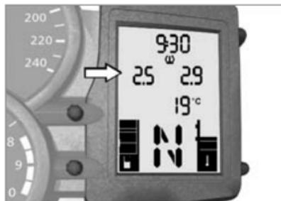
Индикация давления воздуха в шинах чередуется с индикацией счетчика пробега. Левое значение означает давление воздуха в шине переднего колеса, правое значение - давление воздуха в шине заднего колеса. Сразу после включения зажигания выводится индикация «-- --», поскольку передача данных о давлении в шинах начинается только после достижения скорости 30 км/ч.
