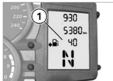
Запас хода **1** показывает, сколько еще можно проехать километров на оставшемся в баке топливе. На мотоциклах без бортового компьютера эта информация выводится только тогда, когда начинает расходоваться резерв топлива. Расчет производится на основании данных о среднем расходе топлива и его количества в баке. Факт заправки регистрируется только тогда, когда в бак заливается несколько литров топлива.
