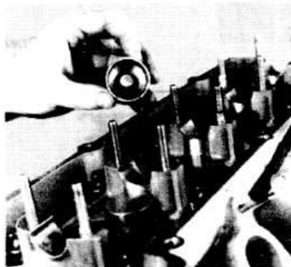
Рис. 3-38. Снятие гидравлических толкателей
