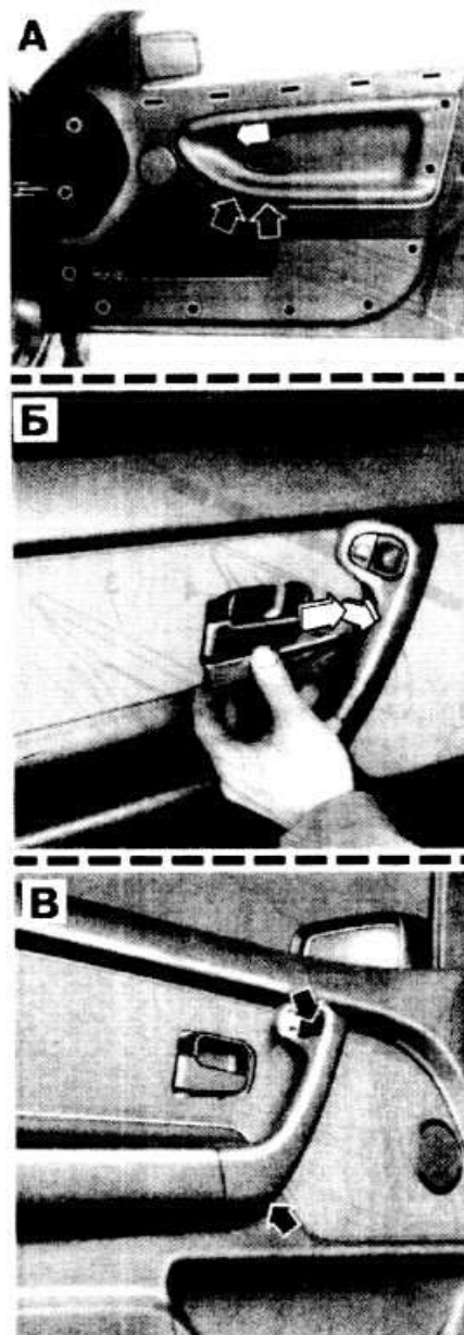
Рис. 15-9. Снятие и установка облицовки передней двери:
