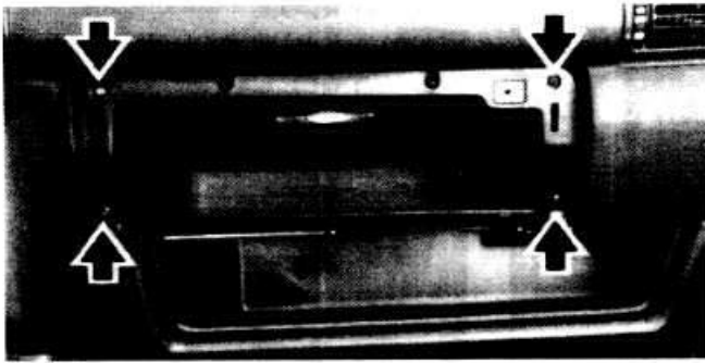
Рис. 16-6. Стрелками показаны винты крепления вещевого ящика автомобилей с дизельным двигателем и кузовом хэтчбек
