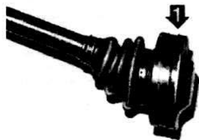
Рис. 9-21. Стрелкой показано место герметизации крышки 1 шарнира равных угловых скоростей
