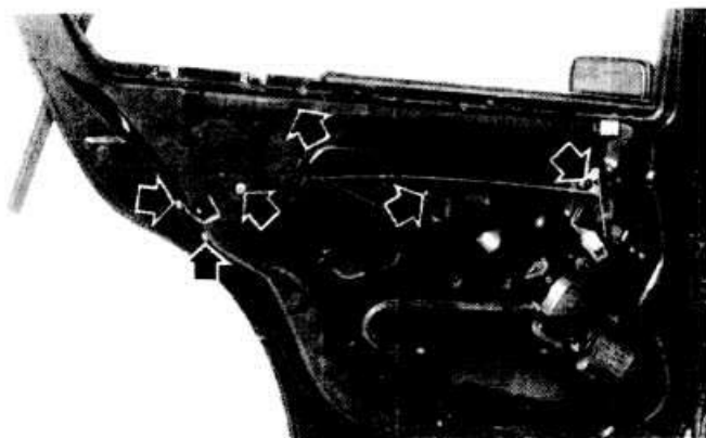
Рис. 15-20. Стрелками показаны винты крепления механизма стеклоподъемника задней двери
