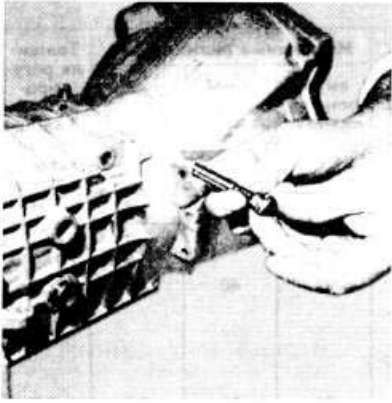
Снятие пробки, пружины и сухаря фиксатора штока выбора передач
