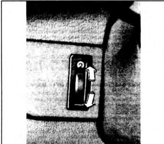
Рис. 1-30. Реостат регулировки яркости освещения приборов
