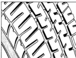
5.17а Расположение указателей износа обозначено сбоку надписью "TWI" и знаком "s". TWI - Tread wear indicator
