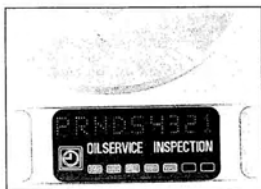
Дисплей индикатора предстоящего технического обслуживания
